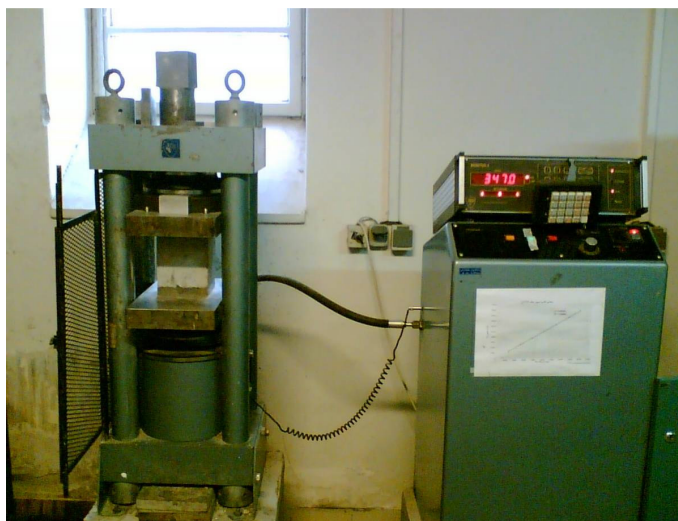
شکل ۲-۳- دستگاه آزمایش تعیین مقاومت فشاری
