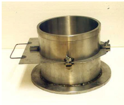
شکل ۴-۵ دستگاه آزمایش ستون جداشدگی
