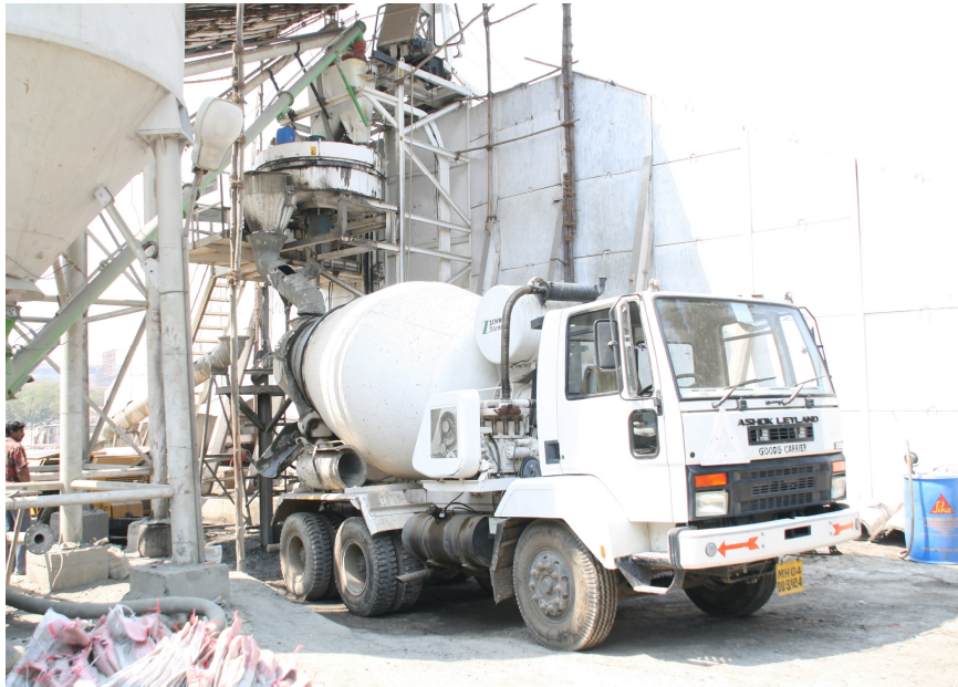
شکل ۳-۴- بارگیری بتن در کامیون مخلوط کن
