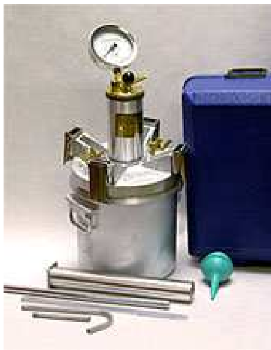
شکل ۳-۴ - دستگاه اندازه گیری درصد هوای بتن به روش ASTM C 231
