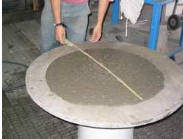
شکل ۸-۴- آزمایش میز جریان
