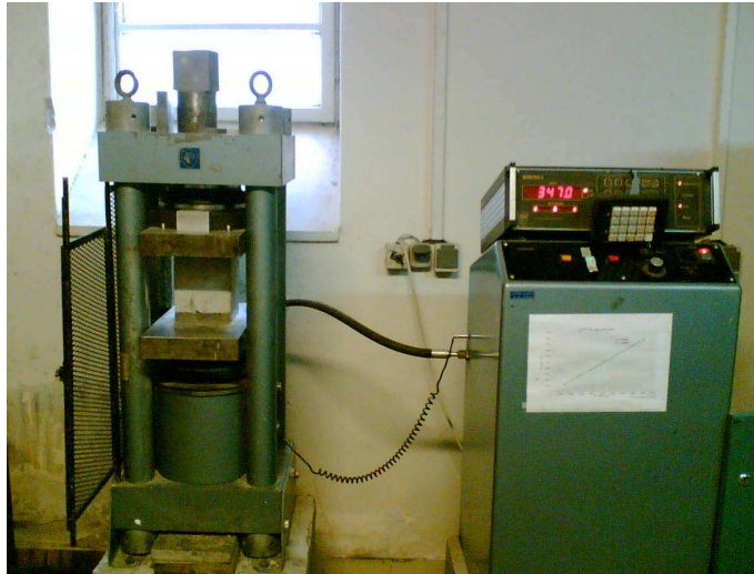
شکل ۳-۲ - دستگاه آزمایش تعیین مقاومت فشاری
