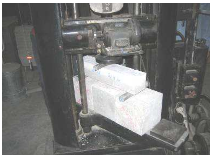
شکل ۳-۴ - دستگاه آزمایش تعیین مقاومت خمشی
