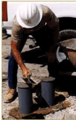
شکل ۸-۲ - نمونه گیری بتن
