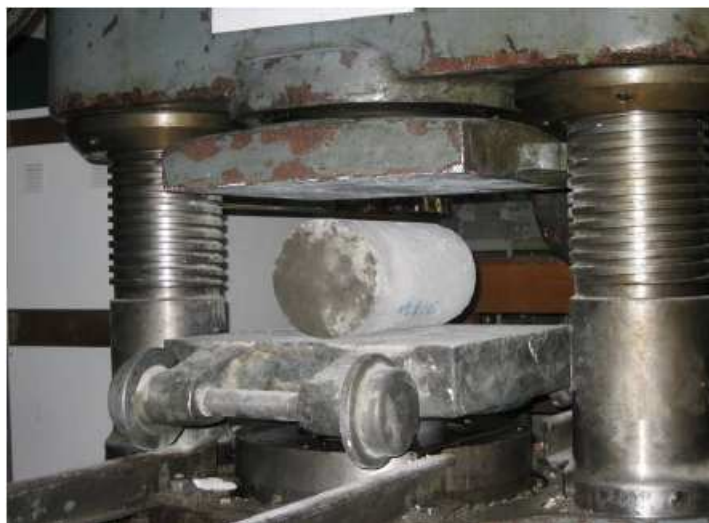
شکل ۳-۳ - دستگاه آزمایش تعیین مقاومت کششی
