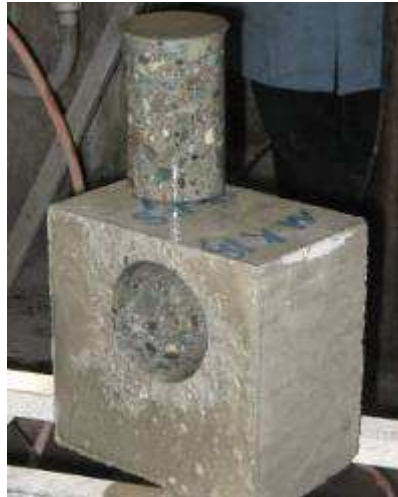
شکل ۳-۵- نمونه مغزه گرفته شده برای آزمایش جذب آب و مقاومت الکتریکی
