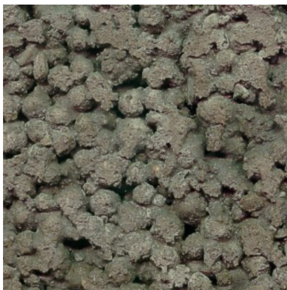
شکل ۳-۱۰- بتن با ساختار باز
