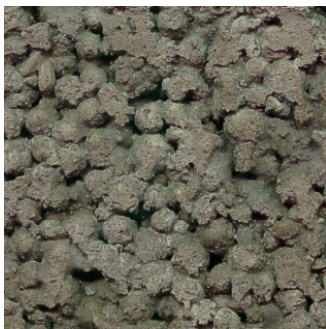
شکل ۲-۷- بافت بتن با ساختار باز
