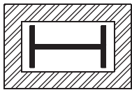
ستون فلزی با حفاظ بلوک لیکا
